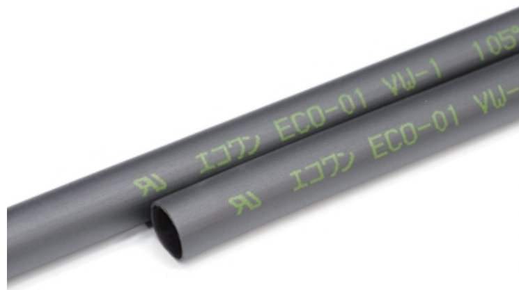
エコワンECO-01 マーキング; UL エコワン ECO-01 VW-1 105℃ 300V E81260-F- NISSEI ECO もしくは600V
