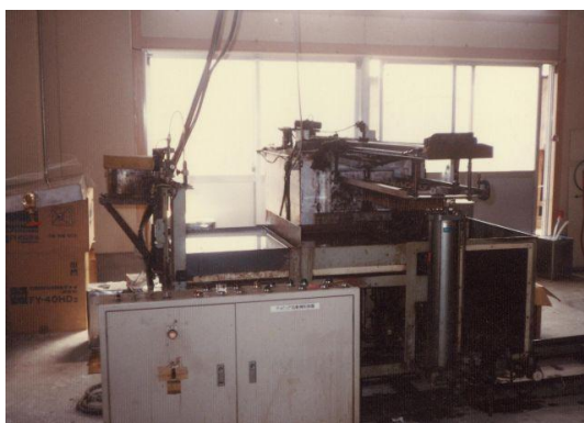
▲初代トランスファマシン 親会社のロータリーマシンと比べると1/4程度のサイズでコンパクトでした
